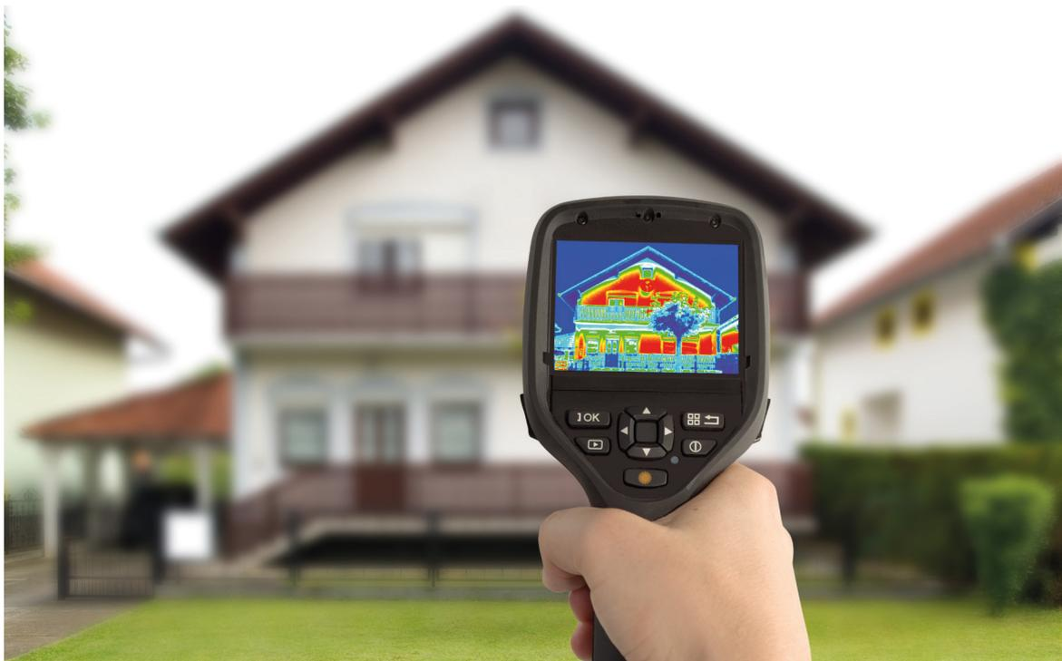
La thermographie infrarouge est une méthode qui permet de détecter les points faibles et les défauts de l'isolation d'un bâtiment dans le but de mieux cibler les éventuelles améliorations à apporter à ce dernier.
